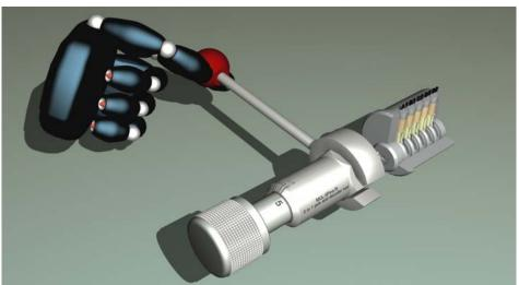
7. 新工具有開鎖和讀碼功能:工具上有刻度: ABCD 12345 開鎖轉動後可以讀出密碼(讀碼需要訓練過的鎖匠)
